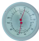
Hiqrometr (havanın rütubətini ölçən cihaz)
