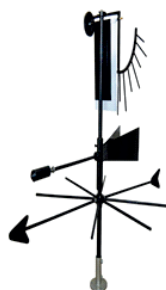
Flüger (küləyin istiqamətini təyin edən cihaz)
