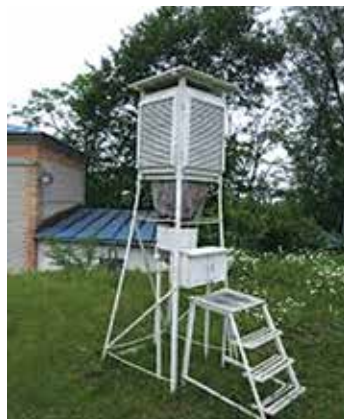
Havanın temperaturunun ölçülməsi üçün istifadə edilən qurğu
