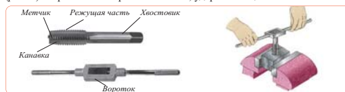
Рис. 7. Нарезание внутренней резьбы метчиком
