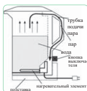
Рис. 2. Устройство электрического чайника
