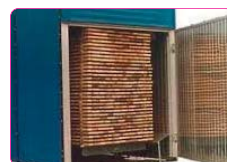
Рис. 2. Сушка пиломатериалов в сушильной камере
