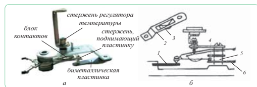
Рис. 3. а – терморегулятор; б – схема регулирования температуры
