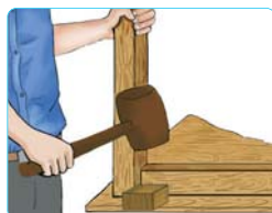
Рис. 4. Применение киянки для ослабления соединений
