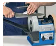
Рис. 2. Заточка ножа на электрическом точильном станке
