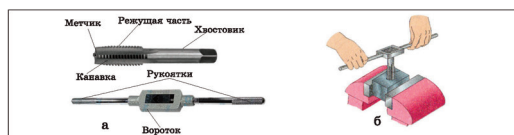
Рис. 7. Нарезание внутренней резьбы метчиком
