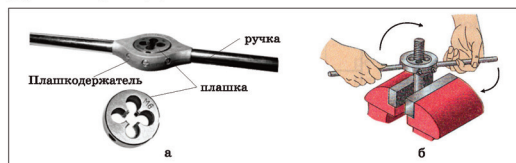
Рис. 6. Нарезание наружной резьбы с плашкой: а) плашка; б) плашкодержатель
