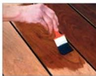
Рис. 2. Нанесение морилки на древесину
