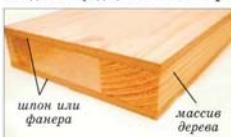
*Рис. 4. Конструкционная особенность столярной плиты*
