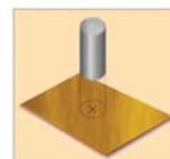
Рис. 6. Высверливание места нагеля
