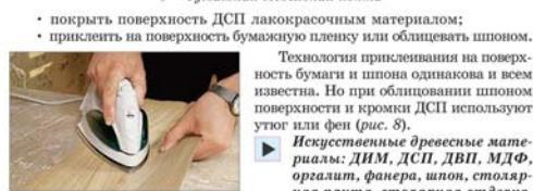
Рис. 8. Наклеивание шпона с помощью утюга
