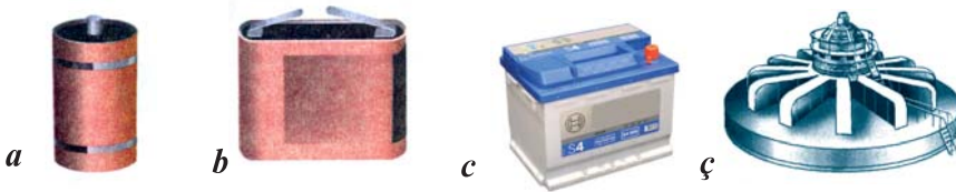
Şəkil 1. Elektrik enerjisi mənbələri: a – qalvanik element; b – qalvanik elementlər batareyası; c – akkumulyator; ç – elektrik generatoru
