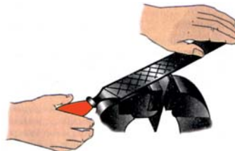
Şəkil 1. Metal lövhənin kənarlarının təmizlənməsi
