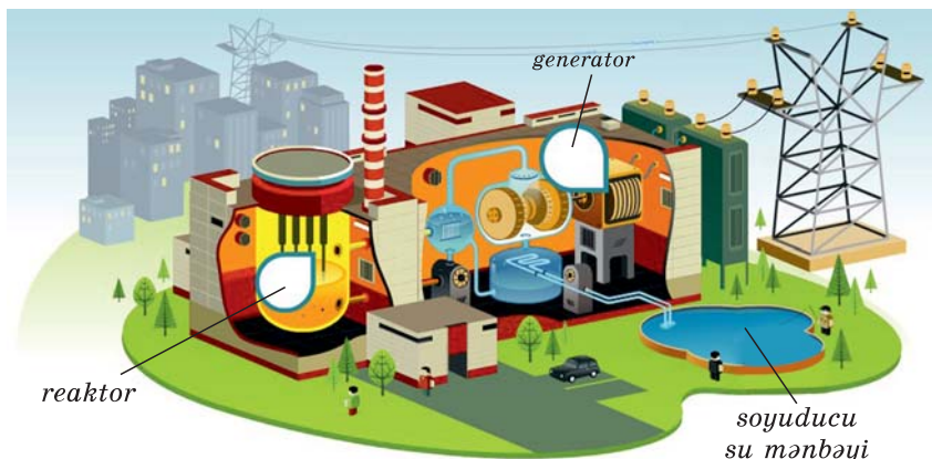
Şəkil 3. Elektrik enerjisinin AES-də alınması
