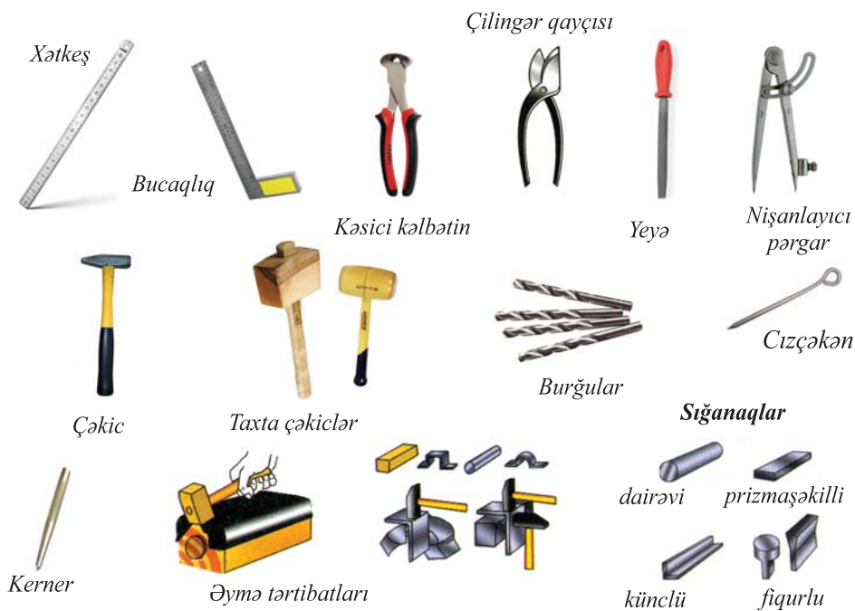
Şəkil 3. Metalın emalı üçün alət və tərtibatlar
