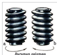
Şəkil 4. Burumların istiqamətinə görə yivlərin növləri: a—sağ yiv, b—sol yiv
