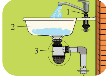
Şəkil 1. Əlüzüyanın quruluşu: 1 – suqarışdırıcı; 2 – çanaq; 3 – sifon
