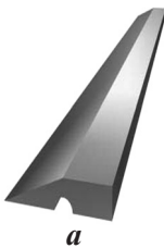
Şəkil 2. Malalama işləri üçün alətlər: a – künyə; b – kəmçə; c – taraz; d – divarın malalanması
