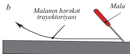
  kil 5. Son malalama texnikası: a – malanın divarda h r k t istiqam ti; b – malanın h r k t trayektoriyası
