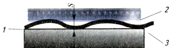
Рис. 3. Проверка качества правки: 1 — проволока, 2 — ребро линейки, 3 — правильная плита
