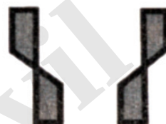
Рис. 3. Расположение лезвий на «левых» и «правых» ножницах.
