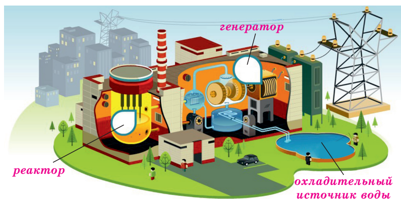
Рис. 3. Получение электроэнергии на АЭС
